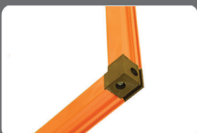
Γωνίες με βίδα που διογκώνει τη γωνία μέσα στο προφίλ
